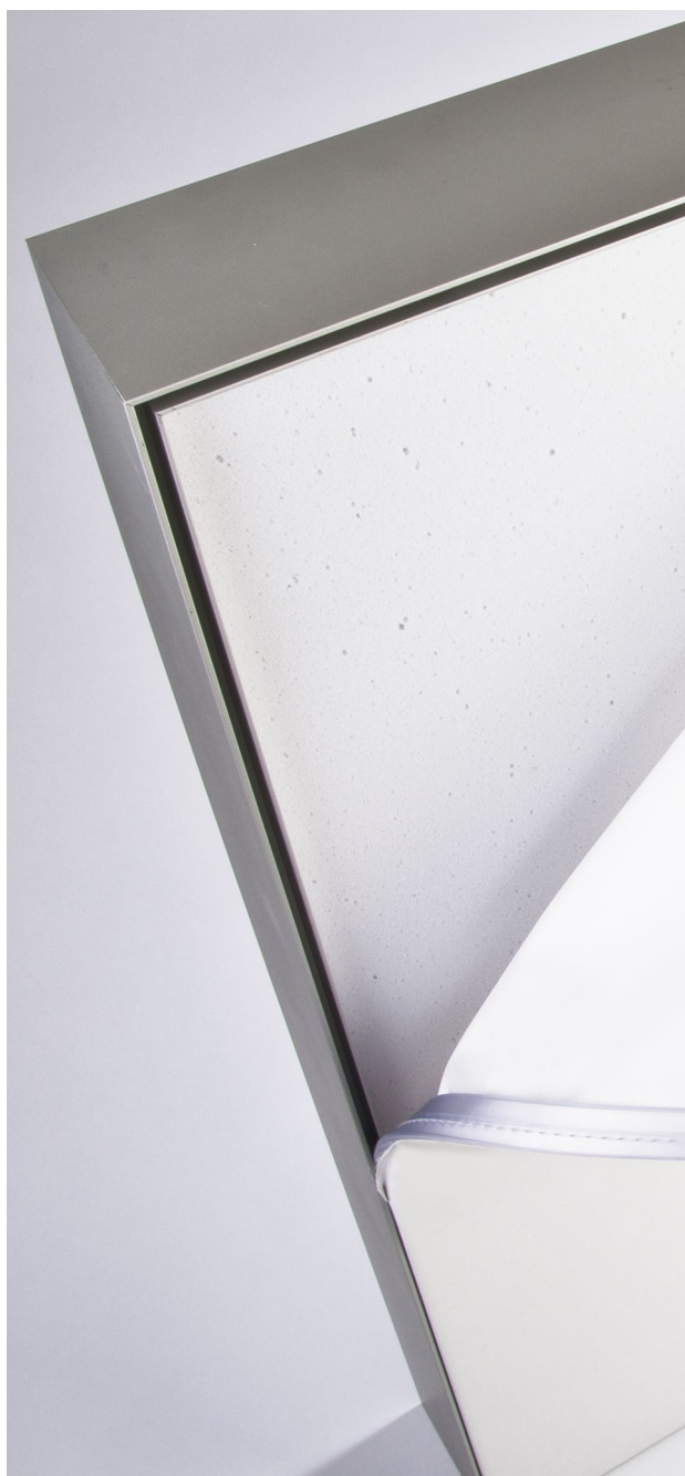
Alurahmen mit umlaufender Nut zur Aufnahme des Wechselketers. Offenzelliger Breitbandabsorber, Spanntuch mit angenähertem PVC-Keder.
